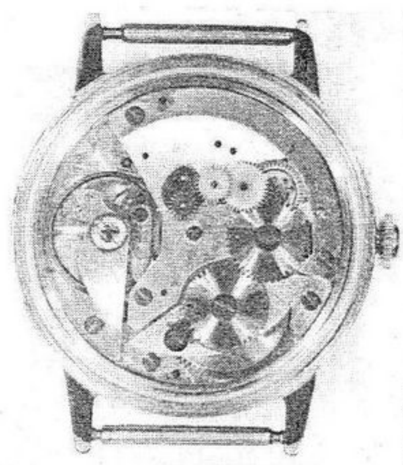
Bild 10. Werk mit entfernter Automaticbrücke
