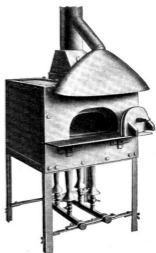
Abb. 13. Muffelofen mit Gasbrennern, ähnlich dem nach Teich, mit dem großen Vorteil, daß kein Gehäus benötigt wird und doch Temperaturen bis 1250° bei geringem Gasverbrauch möglich sind. Er ist also nur an die Gasleitung anzuschließen und äußerst einfach zu bedienen. Diese Ofenart wird auch als Hochtemperaturofen bis 2000° und in sehr kleiner Ausführung für 600 bis 1500° gebaut.
