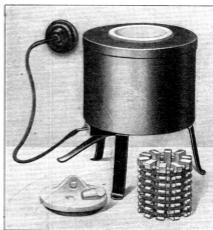
Abb. 16. Elektrischer Tiegelofen für Temperaturen bis 1100°. Kleines, an jede Steckdose anzuschließendes Gerät. Die Anheizzeit auf 900° beträgt 1/2 Stunde. Das Bild zeigt im Vordergrund die herausgenommene Heizspirale. Infolge Kleinheit und Wohlfeilheit ist der Ofen auch für die Uhrmacherwerkstatt geeignet
