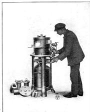
Abb. 12. Ofen mit Öffnung für Temperaturen bis etwa 1250°. Durch die in der Abbildung vorstehenden Einsätze ist der Ofen als Herd-, Muffel- und Schmelzofen zu verwenden. Damit ist er für alle vorkommenden Schmied-, Härte- und Anlaßarbeiten gut geeignet.
