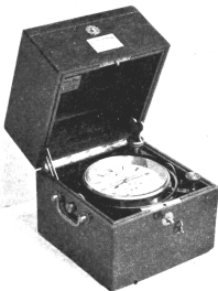
Sechronometer, kleinkalibrig, mit cardanischer Aufhängung im Gehäuse
