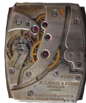
Abb. 20: Tonnenförmiges 10-liniges Kaliber von Niton für A. Lange & Söhne, 18 Steine, zwei Genfer Punzen, Werknummer 4746 (Quelle: Wolfgang Stegemann)
