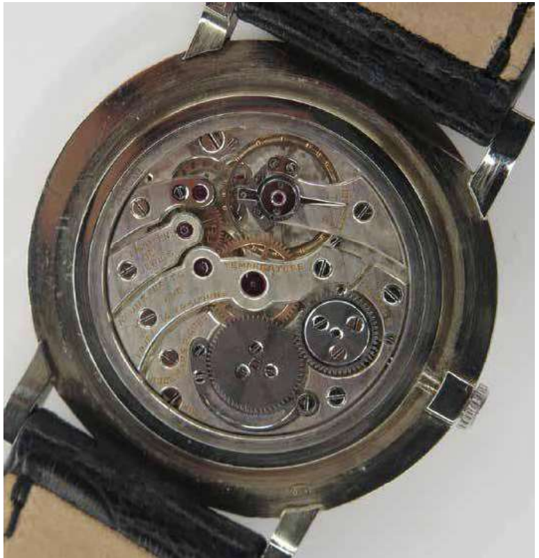
Abb. 42: Kaliber 99P von Frédéric Piguet für Audemars Piguet, deren Bezeichnung lautete Kaliber 9ML (Quelle: AWCo. Amsterdam Watch Co.)
