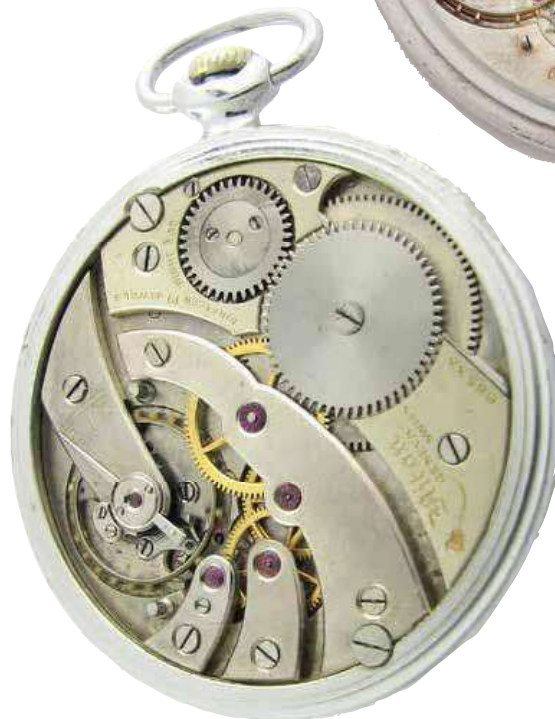
Abb. 50: Taschenuhr, Bucherer, mit springender Stunde und 17-linigem Uhrwerk von Niton, Seriennummer Uhrwerk 88533, 19 Steine, Taschenuhrgehäuse nicht original. Das 17-linige Kaliber wurde von Niton und Edouard Koehn verwendet. (Quelle: eBay)
