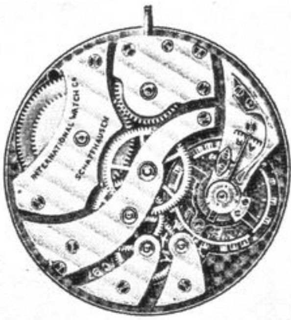
Bild 19 Präzisions-Taschenuhr schweizerischer Klobenbauart, etwa 1960 (mit Genehmigung der International Watch Co., Schaffhausen)
