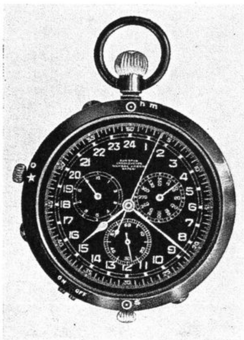
Bild 24. Taschenchronometer für die Flugnavigation mit Angabe der Normalzeit und der Abweichung zur Sternzeit sowie Chronograph (mit Genehmigung der Fa. Ulysse Nardin, Le Locle)
