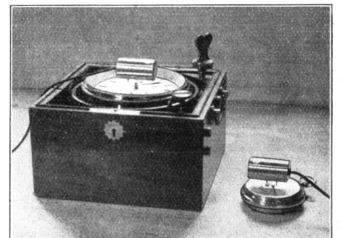
Abb. 5. Aufsatz-Mikrophon auf einem Seechronometer und einer Taschenuhr (5 Zeichn. u. Aufn.: Verfasser)
